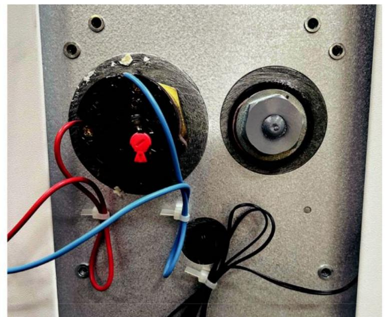
Entfernen Sie die im Bild gezeigten 3 Schrauben der Schutzabdeckung.
